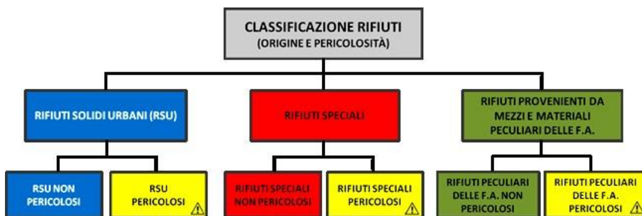
Figura 40 - Classificazione dei rifiuti per origine e pericolosità. Ai rifiuti solidi urbani e ai rifiuti speciali vanno aggiunti i rifiuti peculiari delle F.A., provenienti dalla dismissione e dall'alienazione di sistemi d'arma, mezzi, materiali ed infrastrutture direttamente destinati alla difesa militare.
