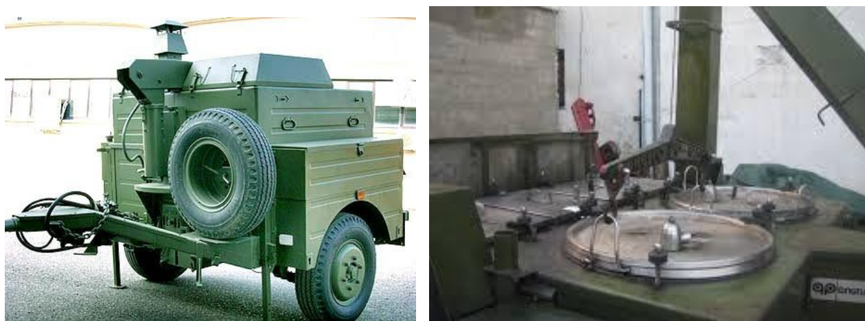
Figura 20 - Alcuni materiali della F.A., quali le cucine rotabili di vecchia generazione, non possono essere vendute o permutate, a causa della presenza di componenti in amianto. Le stesse dovranno essere smaltite a norma di legge, con oneri a carico dell'A.D.
