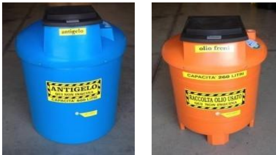
Figura 47 - Fusti, serbatoi per la raccolta di liquidi refrigeranti e liquidi dell'impianto frenante
