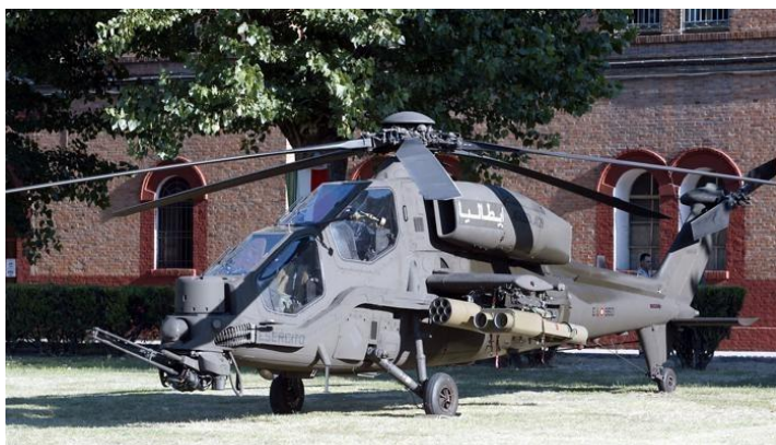
Figura 49 - Negli elicotteri costruiti prima del 1992 vi può essere presenza di amianto nelle guarnizioni delle paratie parafiamma, in guarnizioni, condotti, tubi, rotore, nonché pastiglie dei freni e ruote.
