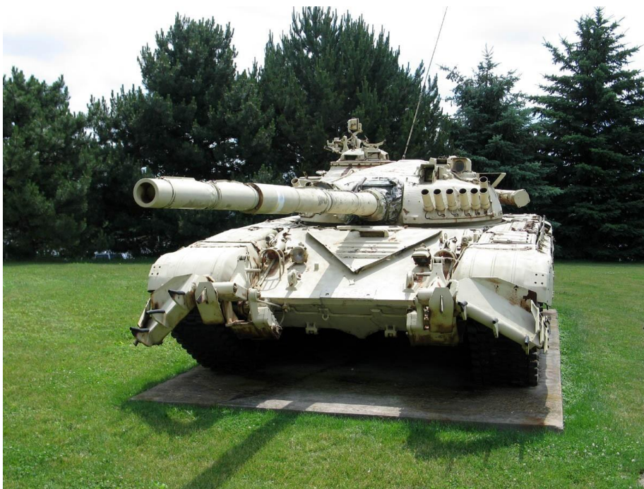
Figura 15 - Carro armato di produzione sovietica T-72 ridotto in mostra statica (demilitarizzato), per scopi museali. Il Trattato CFE prevede la rimozione del motore e degli organi di trasmissione, e interventi sulla bocca da fuoco in maniera da precludere ogni spostamento della stessa sui piani sia zenitale sia azimutale.
