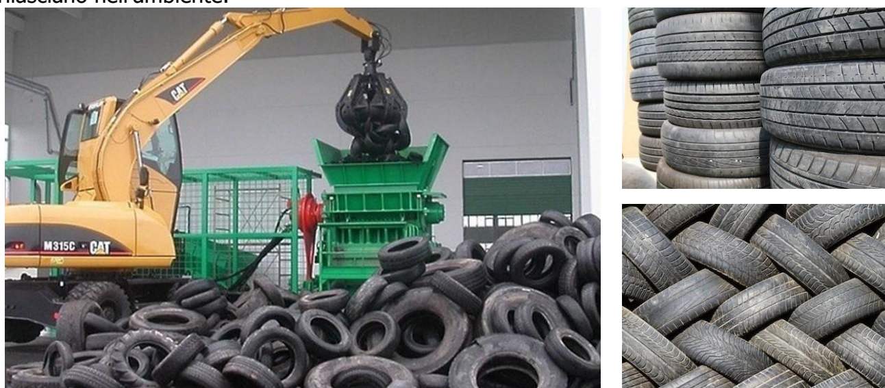
Figura 45 - Gli pneumatici fuori uso devono essere stoccati in depositi temporanei allestiti in un'area delimitata e coperta, con base impermeabile in cemento.
