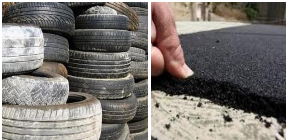
Figura 43 - Tra le varie possibilità di riciclare gli pneumatici fuori uso, vi è anche quella della loro frantumazione per il successivo impiego per lavori stradali (asfaltatura)
