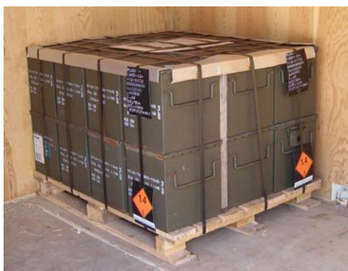
Unità di carico A su pallet NATO standard.
