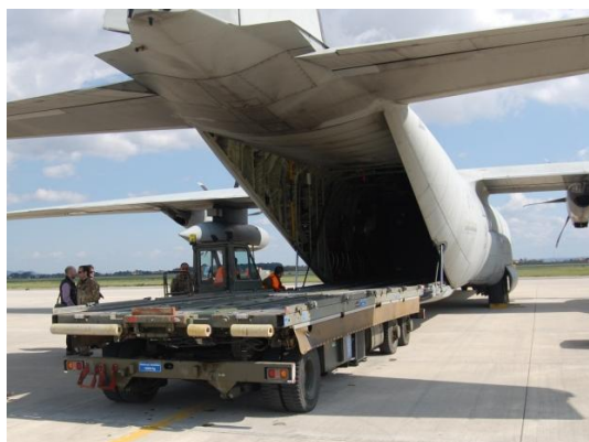
Veicolo speciale con ponte sollevatore ( self-propelled cargo transfer equipment - STANAG 2829) e k-loader (a destra).
