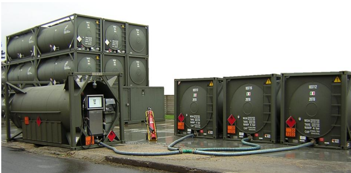
Collegamento in serie (batteria) di shelter carburanti e container tank.
