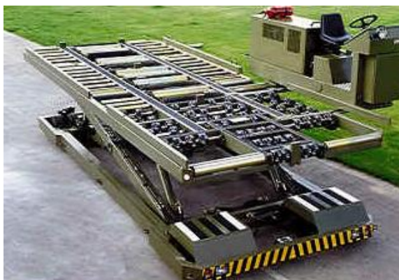
Veicolo speciale con ponte sollevatore ( self-propelled cargo transfer equipment - STANAG 2829) e k-loader (a destra).
