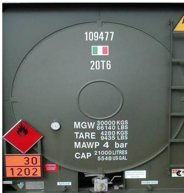
Elementi distintivi di un container tank.
