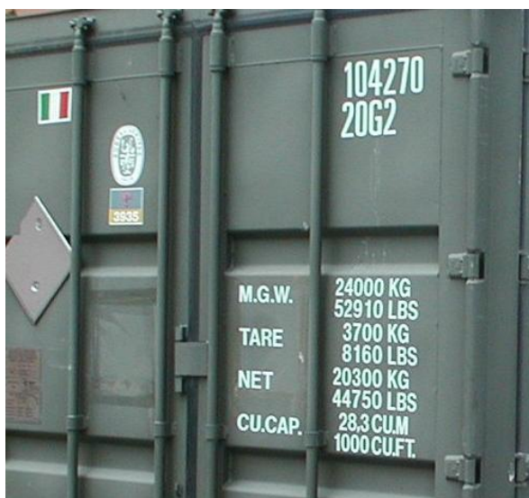
Elementi distintivi di un container open side.
