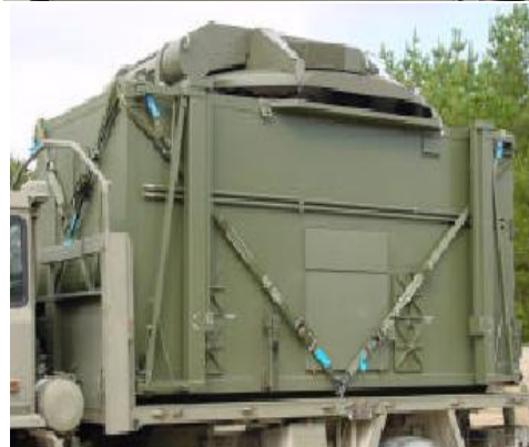
Assicurazione shelter UEO 1 su autocarro medio e leggero tramite cinghie incrociate con gancio terminale.
