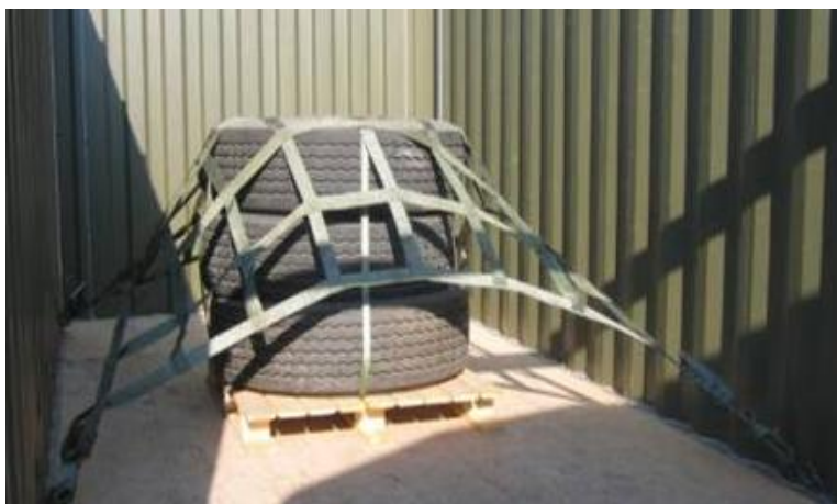
Rete per interno container per carichi orizzontali e verticali.
