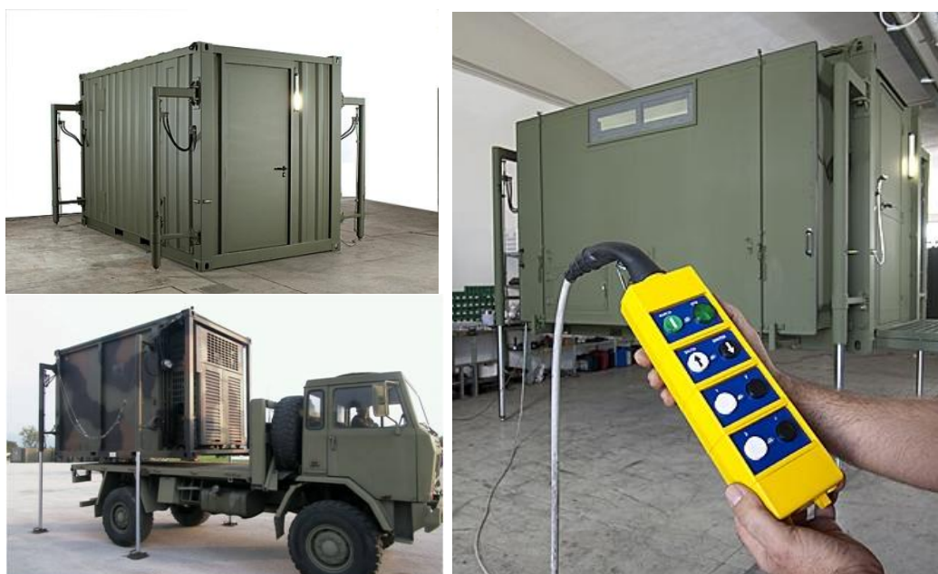
Sistema automatico di sollevamento e livellamento, in dotazione ad alcuni shelter su modulo ISO 1 C e alla maggior parte degli shelter su modulo UEO 1 e 2.
