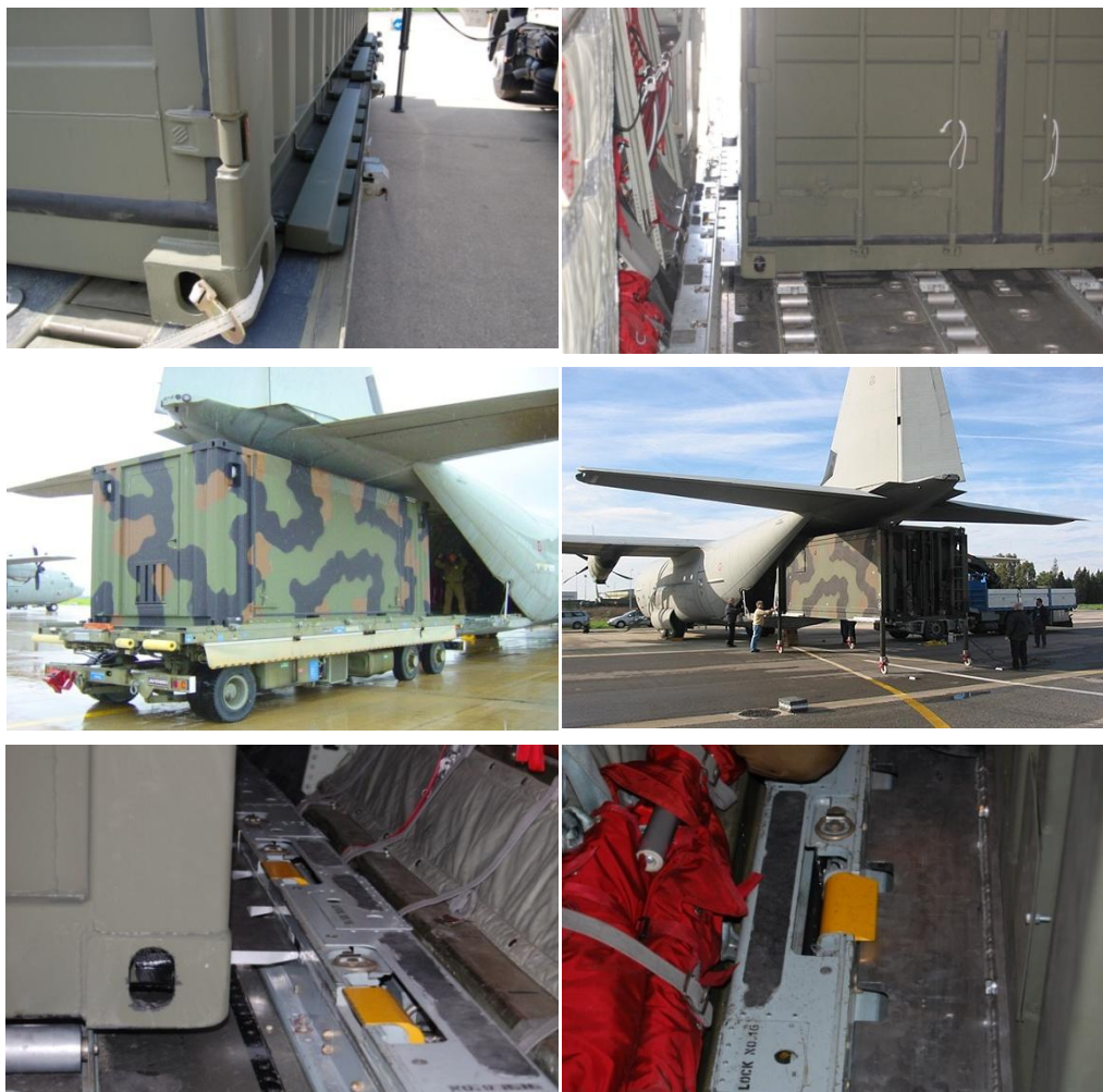
Il container e lo shelter, se dotati di longheroni o longerons , garantisce l'intermodalità, in ambito militare, anche su velivolo Hercules C-130J.
