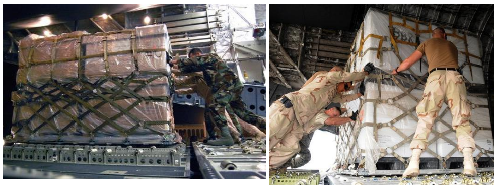
Carichi condizionati su pallet 463L con rete di contenimento per trasporto aereo.
