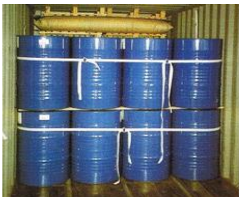
Ancoraggio di un carico con utilizzo di nastro in poliestere e sacco gonfiabile.
