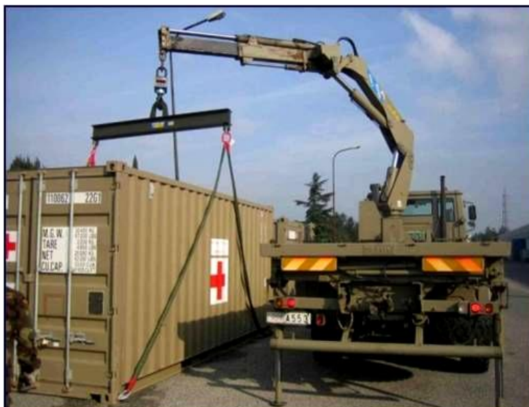
Sistema di sollevamento shelter e container con bilancino, tiranti in poliestere e ganci per blocchi ISO.
