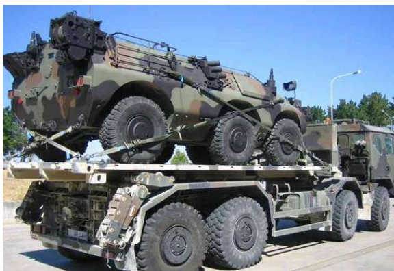
Kit ancoraggio veicoli militari su pianale scarrabile APS: TER 60-2320-7753-10-00B003.
