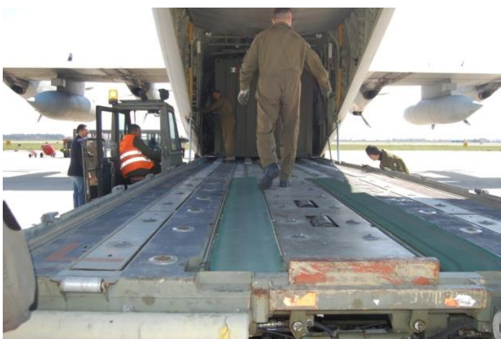
Per l'imbarco e lo sbarco di container e shelter su velivolo Hercules C-130J, l'Aeronautica militare dispone di k-loader, ovvero di carrelli con rullo trasportatore, in grado di spingere i carichi all'interno della stiva del velivolo.
