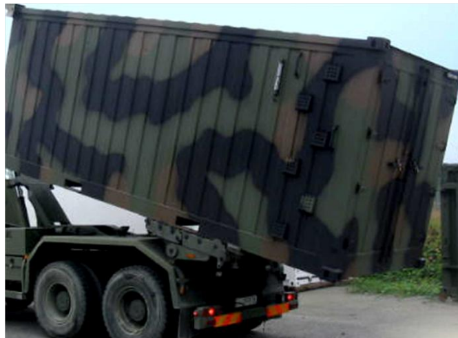
Movimentazione di shelter potabilizzatore, su modulo ISO 1C, tramite autocarro portacontainer con interfaccia di scarramento, a sinistra, e pianale scarrabile, a destra.
