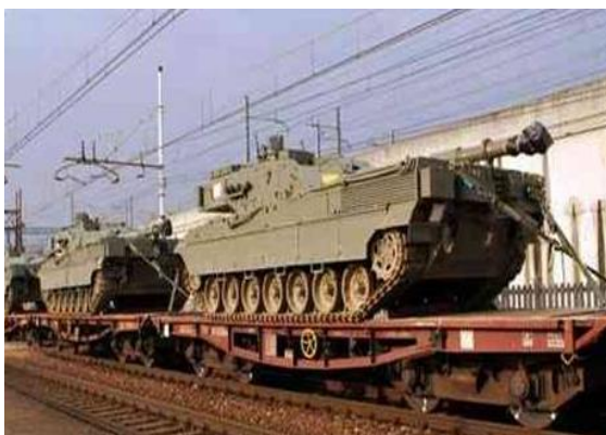
Kit ancoraggio veicoli militari su carri ferroviari: MOT 01-2220-0001-10-01B000.
