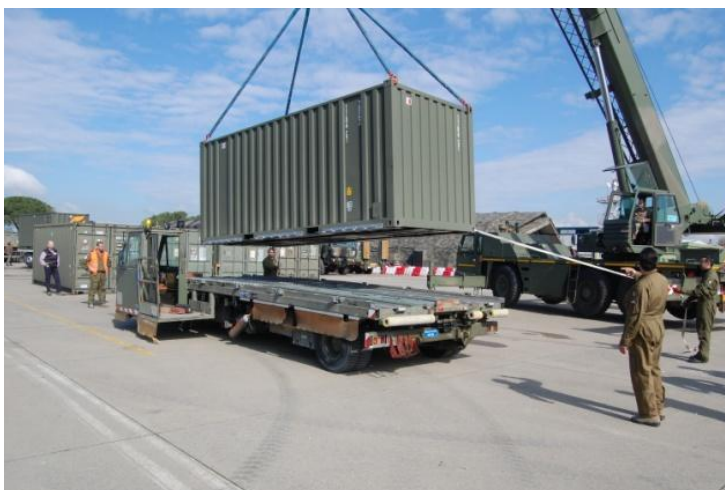
Trasbordo di container da autocarro a k-loader, tramite gru e braca.
