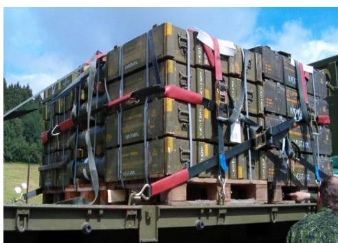
Ancoraggio di pallet in legno per trasporto con autocarro.
