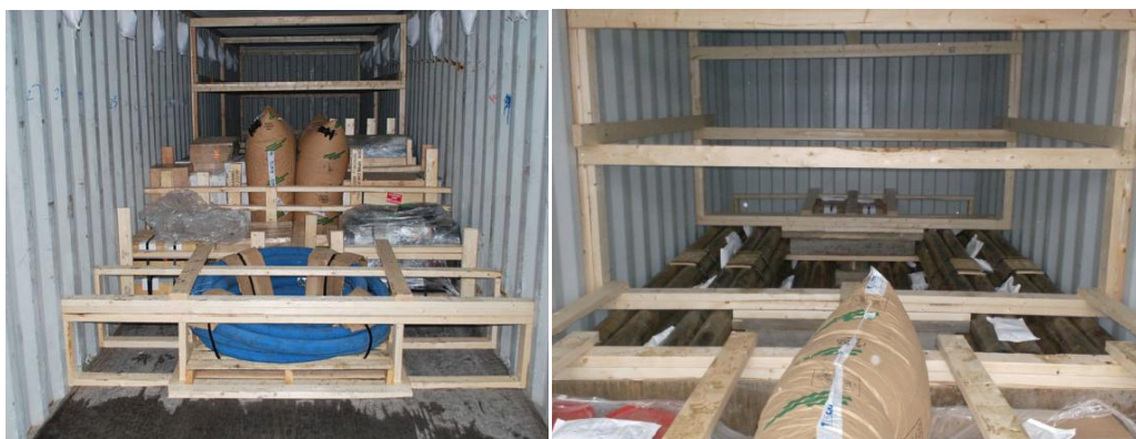
Carico condizionato con travi in legno e sacchi gonfiabili.
