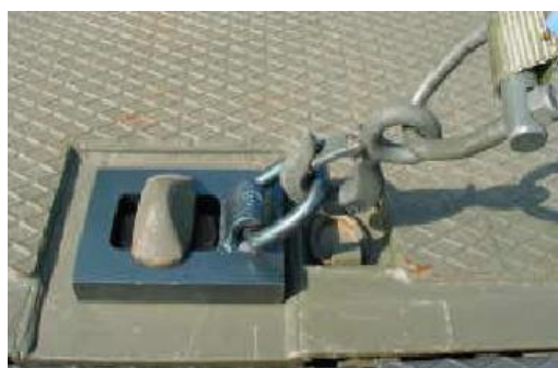
Assicurazione di uno shelter UEO 2 su un pianale di autocarro dotato di twist lock, tramite cinghie incrociate con gancio terminale.
