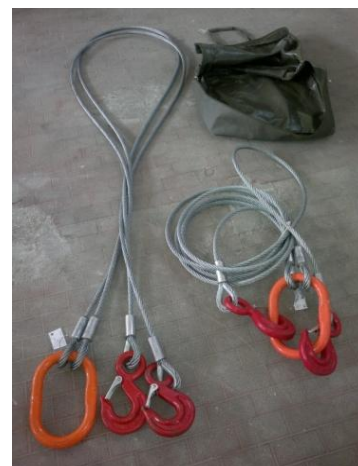
Movimentazione di shelter con autogrù e braca di sollevamento, costituita da quattro funi d'acciaio con relativi accessori.
