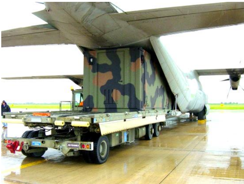
Fasi di caricamento di uno shelter ISO 1C, dotato di longheroni, su Hercules C-130J.
