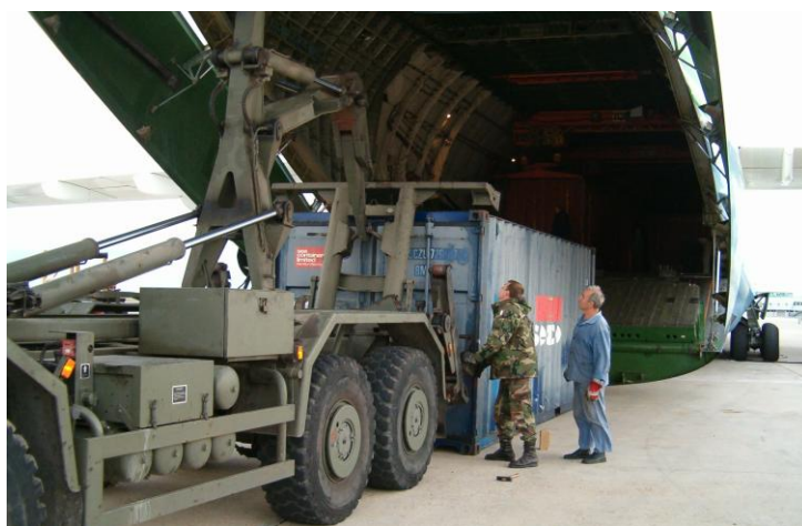
Sistema CHU per movimentazione del container senza pianale scarrabile.
