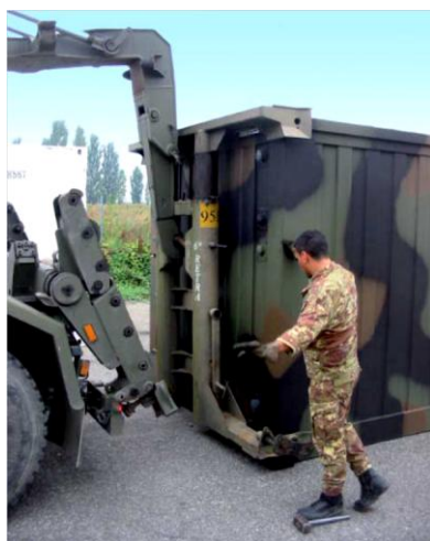
Movimentazione di shelter potabilizzatore, su modulo ISO 1C, tramite autocarro portacontainer con interfaccia di scarramento, a sinistra, e pianale scarrabile, a destra.
