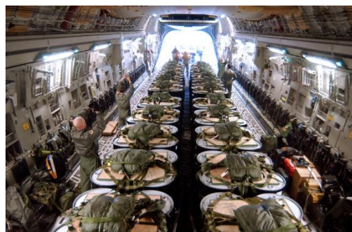
Fusti di carburante su airdrop pallet A-22 in fase di approntamento e di caricamento su velivolo C-17.
