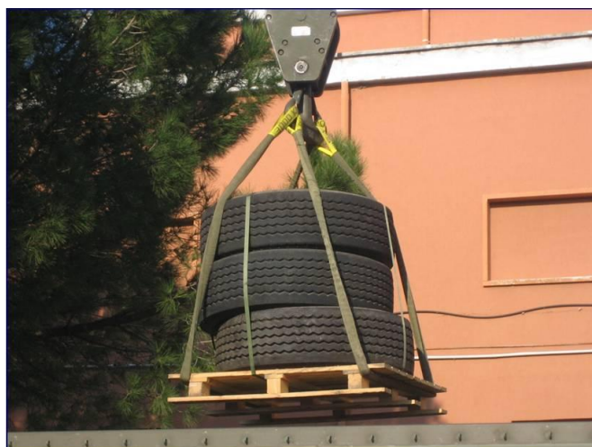
Carico su pallet NATO standard con "ali sporgenti", sollevato con gru e autogrù.
