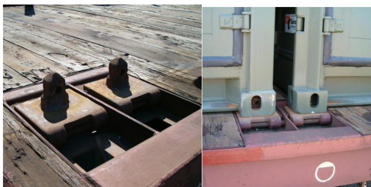
Perni di ancoraggio ribaltabili ISO (spine) di pianale ferroviario e treno portacontainer.
