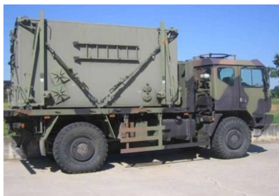
Kit ancoraggio per shelter tipo UEO2 su ACTL: TER 60-2320-7834-12-00B002.
