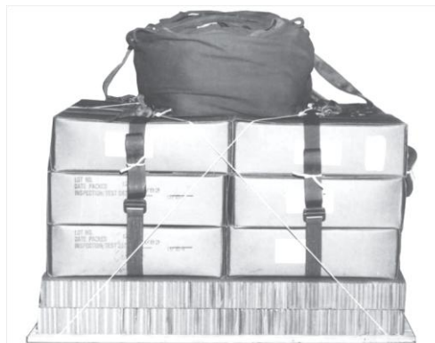
Airdrop pallet A-7A, con quattro cinghie per l'assicurazione del carico (senza telone). Nell'immagine a destra, l'unità è condizionata con base in legno e due strati di materiale ammortizzante ( honeycomb ).
