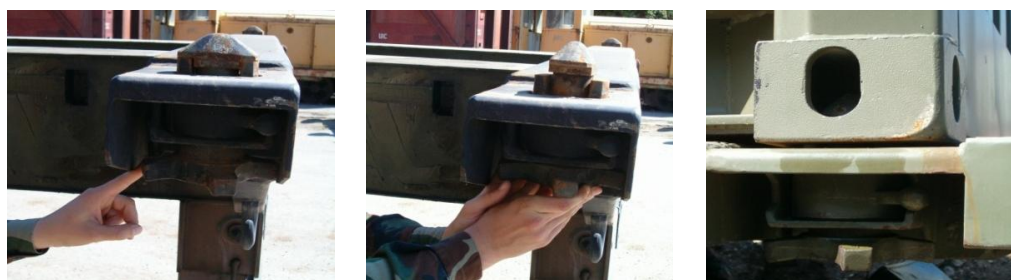
Fasi di innesto del twist lock di autocarro portacontainer.
