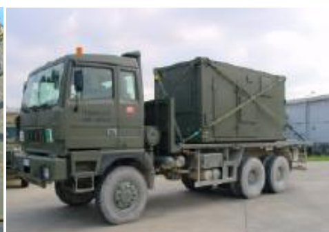
Assicurazione di uno shelter UEO 2 su un pianale di autocarro dotato di twist lock, tramite cinghie incrociate con gancio terminale.
