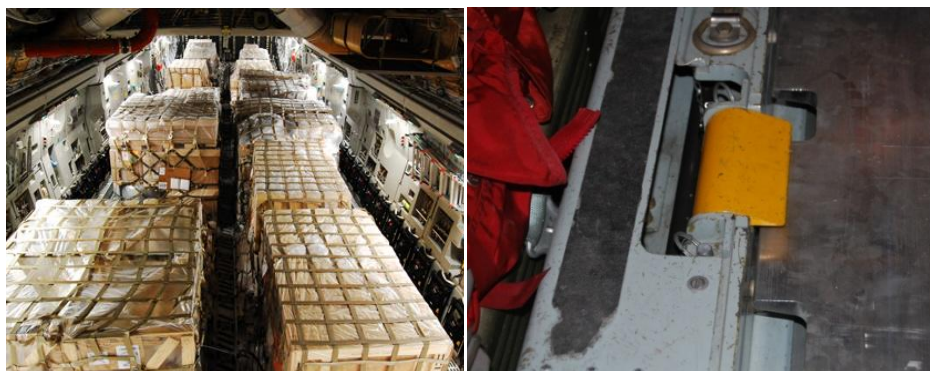
Unità di carico C su pallet per trasporto aereo 463 L. A destra, un dente di ritegno del sistema dual rail per ancoraggio del pallet nella stiva dell'Hercules C-130J.
