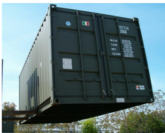
Container "standard" da 20 piedi tipo ISO 1C.
