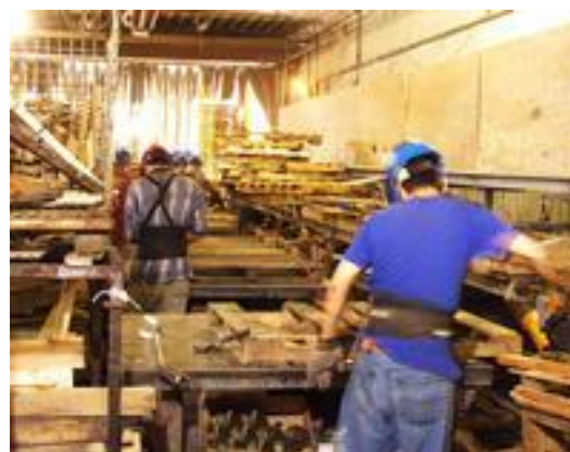
Riparazione di pallet in legno danneggiati: nella fase di smontaggio gli elementi da sostituire vengono rimossi.
