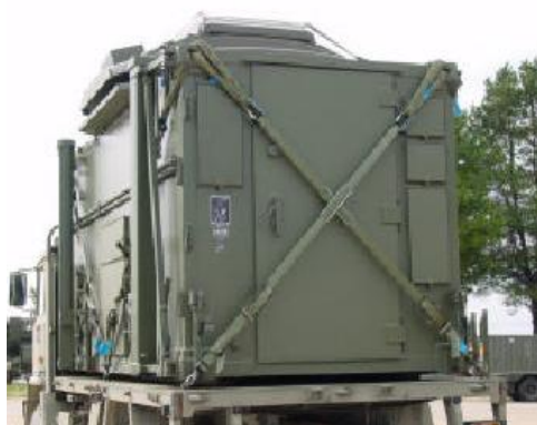
Assicurazione shelter UEO 1 su autocarro medio e leggero tramite cinghie incrociate con gancio terminale.
