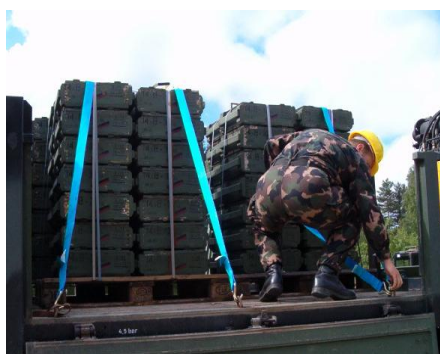
Ancoraggio di pallet in legno per trasporto con autocarro.
