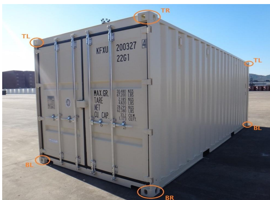
Dislocazione degli otto blocchi d'angolo in un ISO container 29 .
