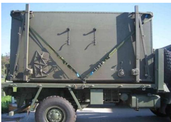
Kit ancoraggio per shelter tipo UEO1/UEO2 su ACM80/90: TER 60-2320-7720-12-00B002.
