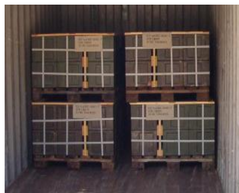
Reggetta in poliestere per ancoraggio del carico su pallet.
