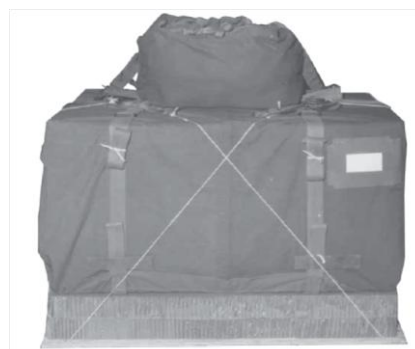
Airdrop pallet A-21. Il telone pieghevole (che costituisce la struttura portante) e le cinghie regolabili consentono varie configurazioni del carico.
