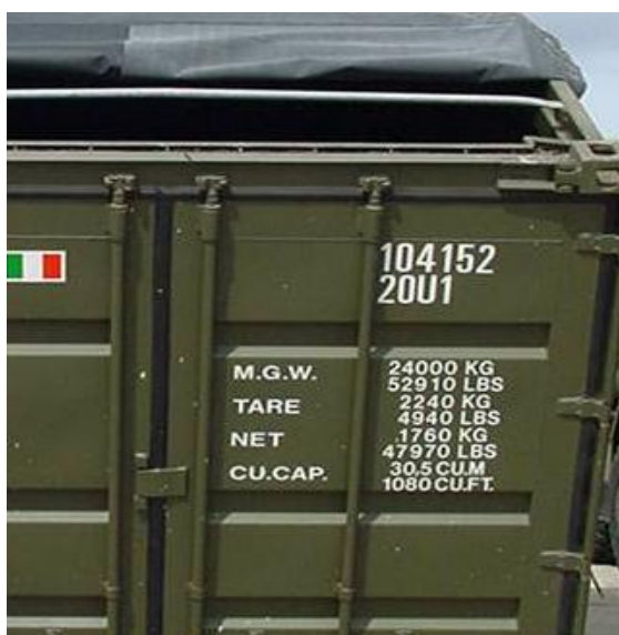
Elementi distintivi di un container open top
