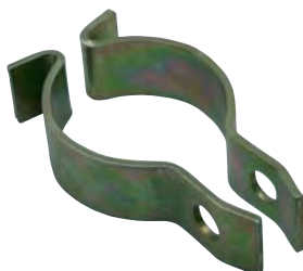
Staffa a doppio collare autostradale in lamiera zincata Art. 2814 per pali Ø 60 Art. 2815 per pali Ø 90
