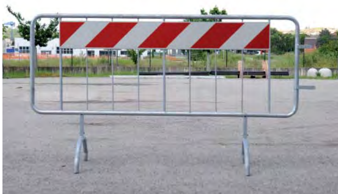
Fig. 2402: misura cm. 110x200 con nr. 6 tondini Ø 8, nr. 3 tubolari quadri 15x15, applicato pannello rifrangente 20x150.
