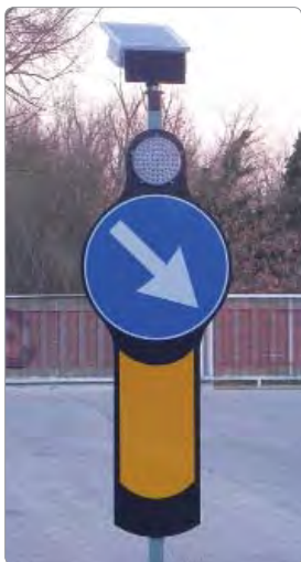
mm. 350x1660 con lampada M200 pannello fotovoltaico disco Ø 600 rifr. cl.2S fig. 82 o 83 C.d.S. palo PVC 60x60x2300
