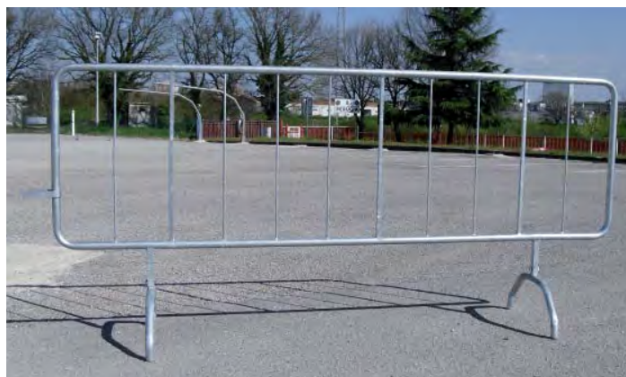
Fig. 2401: misura cm. 110x250 con nr. 7 tondini Ø 8, nr. 3 tubolari quadri 15x15, per eventuale applicazione pannello rifrangente 20x150.
