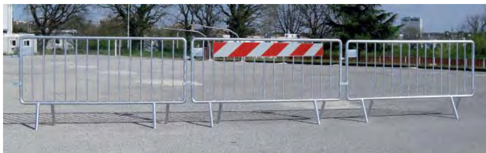
Fig. 2402E: misura cm. 110x200 con nr. 6 tondini Ø 8, nr. 3 tubolari quadri 15x15, applicato pannello rifrangente 20x150.
