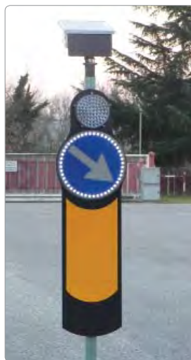
mm. 350x1430 con lampada M200 pannello fotovoltaico disco Ø 400 luminoso fig. 82 o 83 C.d.S. palo PVC 60x60x2000
